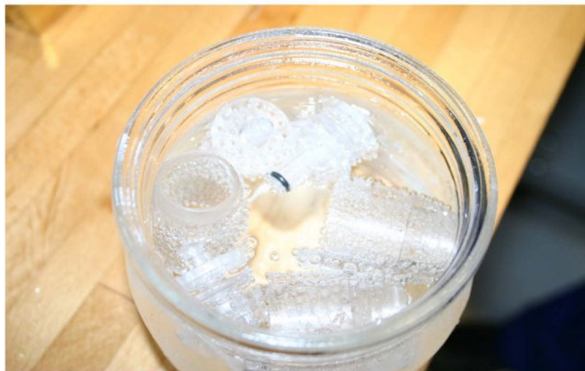
Udløbstude samt difusere lægges i varmt vand (40°C) i 5 minutter Rengøres derefter med blød børste
