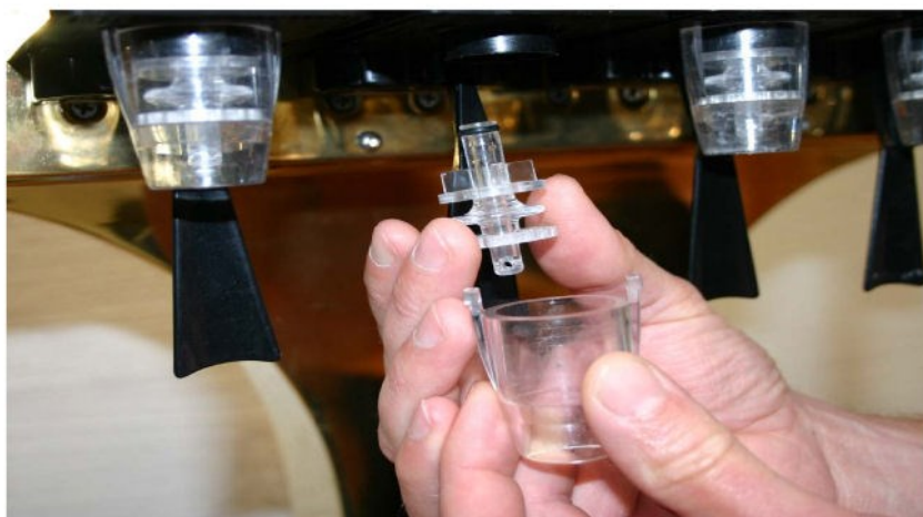
Udløbstud afmonteres ved drejning – derefter afmonteres difuser
