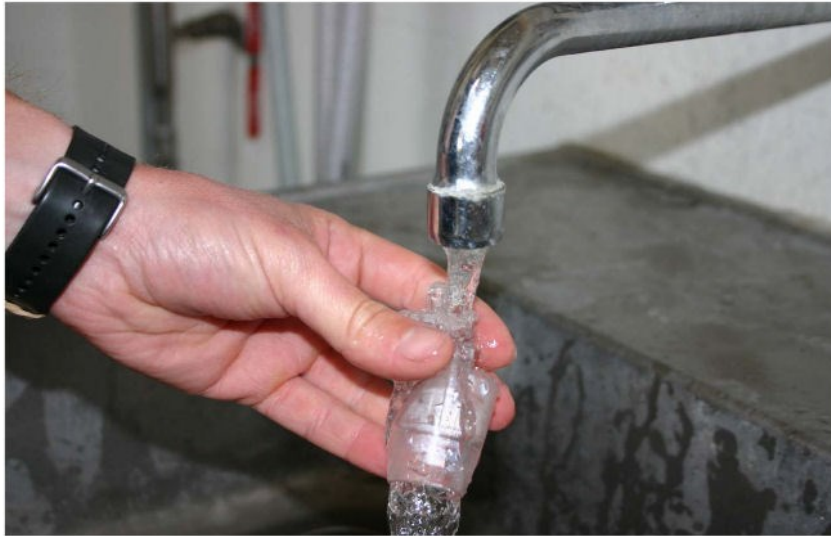
Udløbstude samt difusere skylles under lunken vand og isættes derefter i postmix hane
